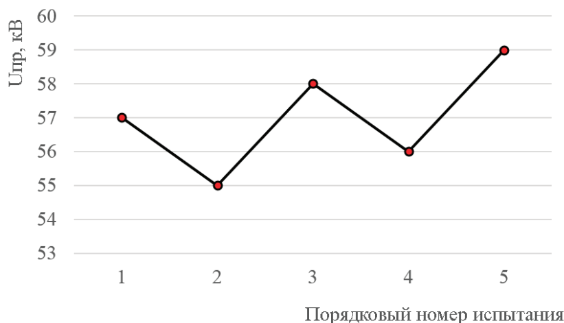
Рис. 1. График изменения пробивного напряжения масла силового трансформатора ТДН-63000/110
