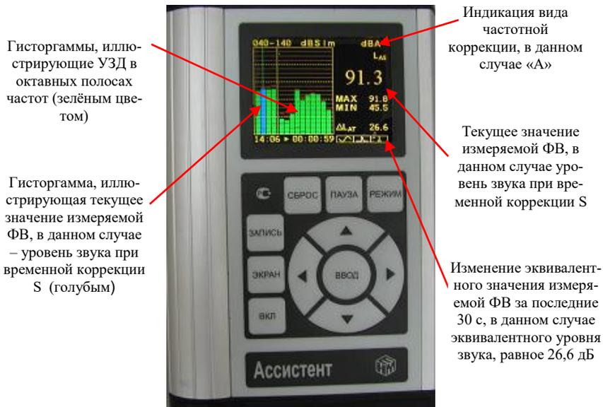
Рис. 2. Передняя панель шумомера
